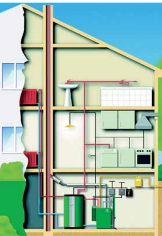
Einbindung einer Blockheizkraftwerk-Anlage in einem kleinen Wohngebäude.
